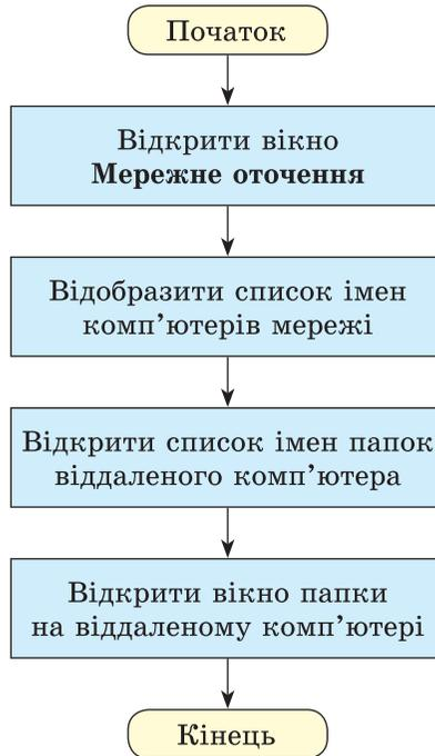
Рис. 5.8. Блок-схема алгоритму здійснення навігації локальною мережею
